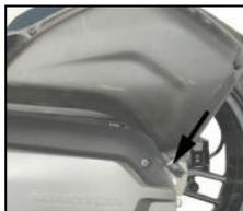
Zum Ablassen des Öls wird die Schelle gelöst und nach oben bewegt, der Stopfen des Ölakkumulationsrohrs aus dem Ölakkumulationsrohr gezogen und das im Ölakkumulationsrohr akkumulierte Öl abgelassen.
