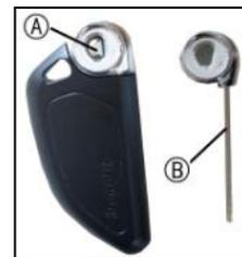
appuyez sur le bouton en haut du boîtier (A) pour retirer la clé de secours (B). Pendant la conduite, emportez une clé avec vous et placez l'autre clé dans un endroit sûr en réserve. Pour obtenir une clé supplémentaire, veuillez contacter le centre de service après-vente.
