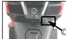
Nähe der Antennenposition (ca. 4-5 cm). Die passive schlüssellose Zugangskontrolle (PKE) kann den Fernbedienungsschlüssel erkennen und das Stromschloss entriegeln.
