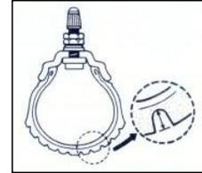
La profondità del disegno sulla banda di rotolamento dei pneumatici dovrebbe essere uguale o superiore a 0,8 mm; se l'usura è inferiore a 0,8 mm, sostituire con pneumatici nuovi. Pneumatici con usura anomala possono essere estremamente pericolosi durante la guida.
