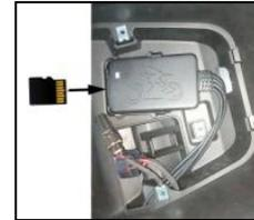
protector trasero. Inserte la tarjeta TF directamente en la ranura hasta escuchar un "clic"; luego empuje ligeramente la tarjeta TF hacia adelante para que se expulse y pueda retirarla. Para una nueva tarjeta TF, formatee primero en una computadora, el formato de la tarjeta debe ser FAT32.
