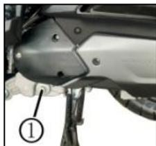
(6) Riavvitare e stringere la vite di scarico dell'olio del motore.
