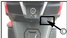
della chiave elettronica a distanza. Quando la chiave elettronica a distanza è scarica, avvicinate la chiave all'antenna (a circa 4-5 cm di distanza). Il controllo senza chiave (PKE) può rilevare la chiave e permettere l'operazione di sblocco del blocco elettrico.
