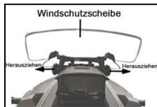
Höhenverstellhebel mit beiden Händen heraus und drücken Sie ihn gleichzeitig nach oben oder unten, um die Höhe der Windschutzscheibe einzustellen.
