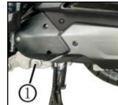
(5) Führen Sie mehrere Startvorgänge durch, um das Motoröl vollständig zu entleeren;
