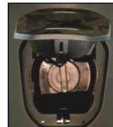
réservoir de carburant, le couvercle du réservoir étant sous ce couvercle. Lors du ravitaillement, tournez et retirez le couvercle du réservoir pour faire le plein .
