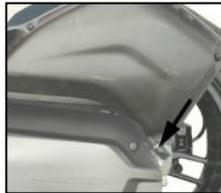
El método de operación de drenaje es: aflojar la abrazadera y moverse hacia arriba, saque el tapón de la tubería de acumulación de aceite, descargue el aceite acumulado dentro de la tubería de acumulación de aceite.
