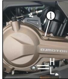
Lorsque le niveau d'huile est inférieur à la position L de l'échelle inférieure, ouvrez le bouchon de remplissage supérieur ① et ajoutez de l'huile jusqu'au milieu des échelles supérieure et inférieure.
