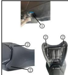
Retirer les vis ② des deux côtés du coussin du siège du
