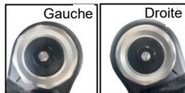
d'amortissement de rappel, et les tourner dans le sens inverse des aiguilles d'une montre (sens S) diminue la force d'amortissement de rappel. Le réglage nécessite que les amortisseurs gauche et droit soient réglés au même niveau de force d'amortissement.
