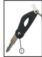
Appuyez sur le bouton ① de la clé pliable pour déployer ou rétracter la tête de la clé.
