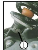
devient également plus grande ou plus petite, modifiant ainsi le rebond lent ou rapide de l'amortisseur, l'écrou de réglage de la force d'amortissement pour chaque réglage d'un engrenage lorsqu'un « caquètement » se fait entendre. Il est marqué en usine et il est conseillé aux clients de ne pas l'ajuster eux-mêmes.
