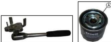
③ Utilisez un nouveau filtre à huile du même modèle, et appliquez une couche de lubrifiant sur le joint torique ①.
