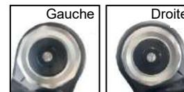
(direction H) pour augmenter la résistance de l'amortissement, et dans le sens antihoraire (direction S) pour la diminuer.
