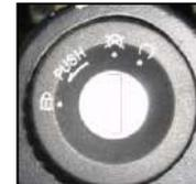
Marque "⊙" : ..... Lorsque la clé est tournée en position "⊙", l'alimentation est connectée, le moteur peut démarrer et la clé ne peut pas être retirée;
