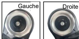
augmenter la résistance de l'amortissement, et dans le sens antihoraire (direction S) pour la diminuer.
