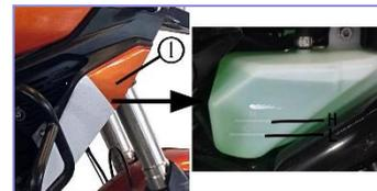
pour moteur à base d'éthylène glycol et compatible avec les radiateurs en aluminium. Utilisez le liquide de refroidissement d'origine recommandé par le fabricant, car l'utilisation d'autres types de liquides/mélanges peut endommager le moteur.
