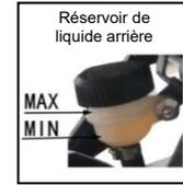
situé au-dessus du guidon droit. Si le niveau est en dessous du marqueur MIN, ajoutez du liquide de frein spécifié ; le réservoir de liquide arrière est situé sur le côté droit du véhicule, le niveau doit se situer entre les marques MIN (ou LOWER) et MAX (ou UPPER). Si le niveau est en dessous de MIN (ou LOWER), ajoutez du liquide de frein spécifié. Le remplacement du liquide de frein doit être considéré comme une partie de l'entretien régulier.
