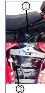
Pour installer le siège, poussez le siège de l'arrière vers l'avant, laissez les crochets à l'arrière du siège s'engager dans les fentes correspondantes, puis
