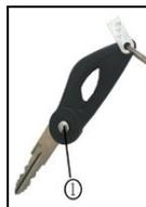
Appuyez sur le bouton ① sur la clé pliable pour étendre ou rétracter la tête de la clé.
