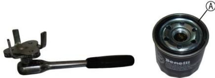
③ Utilisez un nouveau filtre à huile du même modèle, et appliquez une couche de lubrifiant sur le joint torique **A**.
