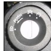
Marque "○" : ..... Lorsque la clé est tournée en position "○", l'alimentation est connectée, le moteur peut démarrer et la clé ne peut pas être retirée;
