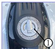
Pour faire le plein, ouvrez d'abord le couvercle anti-poussière du réservoir de carburant ①, puis insérez la clé du réservoir et
