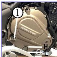
d'huile si le niveau se situe entre les lignes graduées L et H. Si le niveau d'huile est en dessous de la ligne graduée L, ouvrez le bouchon de remplissage supérieur ① et ajoutez de l'huile jusqu'à ce que le niveau atteigne le milieu entre les lignes supérieure et inférieure.
